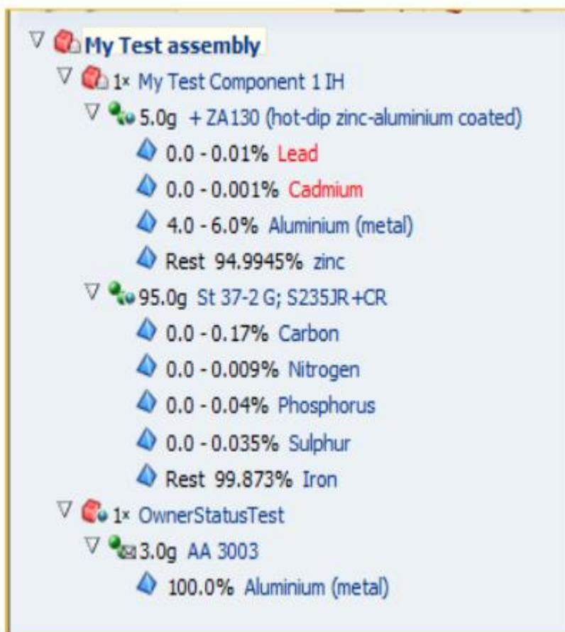
Abbildung 11: Beispiele von einer Komponenten-Baumstruktur (HEWLETT PACKARD 2013)
